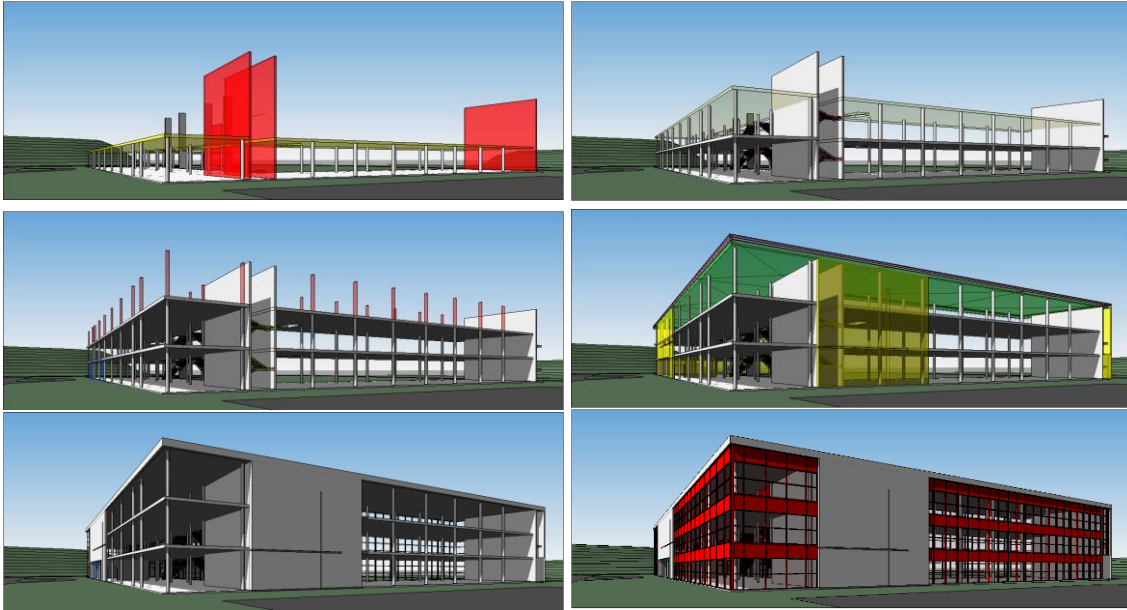
Estados sucesivos de la ejecución
