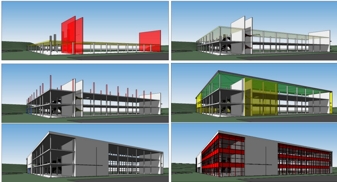
Estados sucesivos de la ejecución
