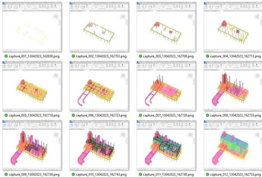
Secuencia BIM4D de la planificación
